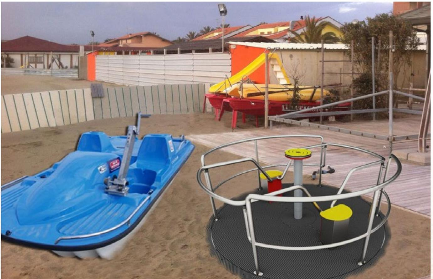
Sarà possibile effettuare **escursioni in mare** grazie a “Vengo anch’io... SSSI”, un pedalò a pedalata assistita con motore elettrico ricaricabile tramite pannello solare e con la pedaliera a mano per farlo utilizzare anche alle persone con lesione midollare. Il pedalò sarà anche munito di un segnalatore GPS per rintracciare velocemente l’imbarcazione.
